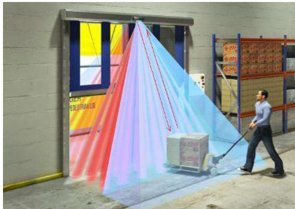
Gambar 9. Cara kerja pintu otomatis (Anonim, 2016)
