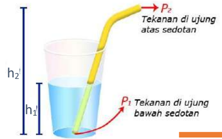
Gambar 6. Perbedaan Tekanan di Ujung Atas dan Bawah Sedotan. (Subekti, 2014)
